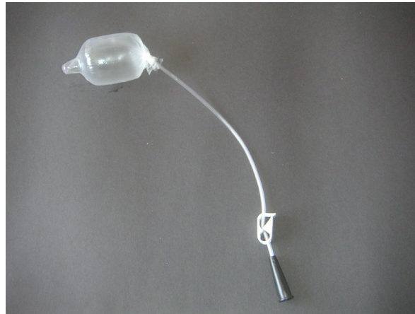
Abb. 8: Funktionstest, der Ballon ist dicht.
